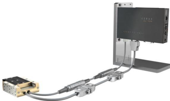
ELAX®系列直线电机滑块和 ROTAX®系列旋转电机：这两个型号都采用单导线解决方案，集成了电机电缆和传感器数据线。可以使用上述 LINAX®中提供的三种连接方式。但是对于选项三，由于特殊的 EMV 保护，最多仅可以使用一根转接线。
