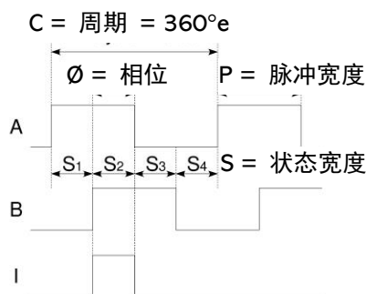
图2 A与B正交信号和参考信号的编码器输出信号。
