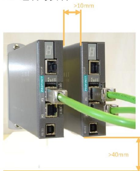
我们建议垂直安装本设备，确保冷却空气循环流通。
