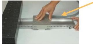
启动后，LINAX®或ELAX®直线电机将自动进行回零，然后前后运动之前手动指示的距离。
